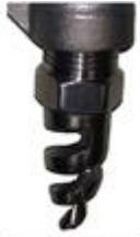
Los lavadores de la **serie LV-SC** emplean aspersores especiales tipo Spiral Jet SPJ 316 L (abertura amplia) para inyección de líquido de lavado, proporcionando un patrón de aerosol sólido en forma de cono, con área de impacto circular. Son construidos por mecanizado especial en una sola pieza y diseñados para proporcionar alta eficiencia energética, con
