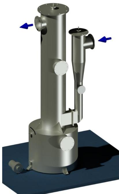
El equipo Venturi emplea un mecanismo de cambio de presión para pulverizar el agua inyectada a manera de spray en su garganta, en donde se pulveriza, con lo cual se aumenta la probabilidad de choque con las partículas contaminantes. Posteriormente esta niebla es separada en el separador ciclónico y eliminador de nieblas. Como características principales del sistema se tiene:
